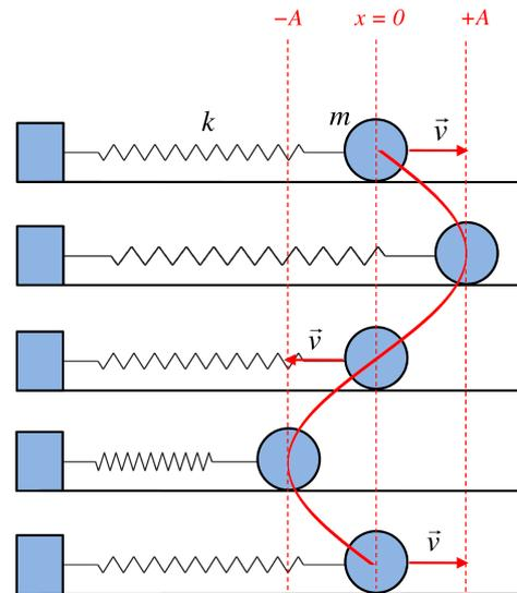
Figura 2: Sistema massa-mola. O deslocamento máximo  $A$ , medido em relação ao ponto de relaxamento da mola, é chamado de amplitude.
