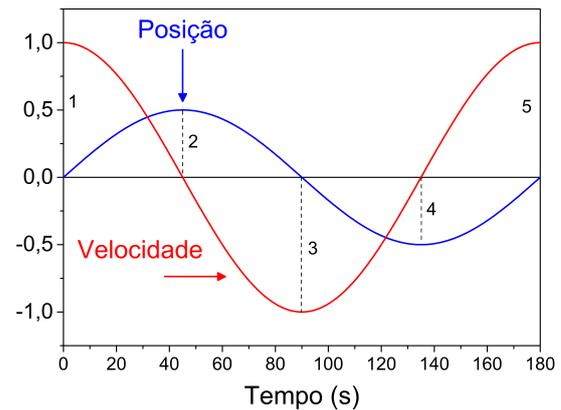
Figura 4: Posição (m) e velocidade (m/s) de uma partícula em MHS assumindo  $A = 0,5 \text{ m}$ ,  $\omega = 2,0 \text{ rad/s}$  e  $\phi = 0$  nas equações 16 e 17.
